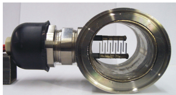
Rußladungssensor im Abgasrohr
