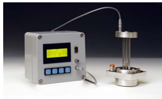
Labormuster eines akustischen Binärgassensors mit Elektronikeinheit
