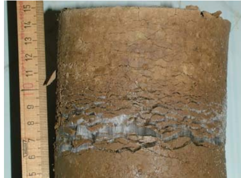
Durch Eislinsenbildung zerstörte Bodenprobe
