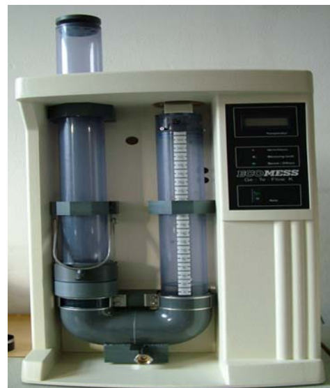
Bestimmung der Durchlässigkeit von Geotextilien ohne Auflast
