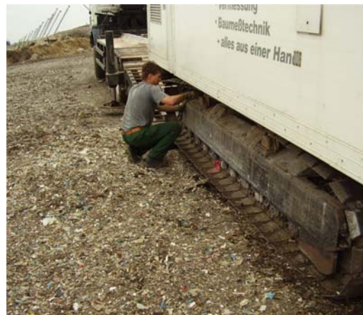
Drucksondierung auf einem Probefeld mit MBA Material
