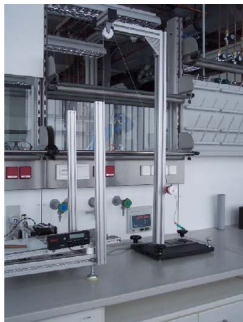
Gleitwinkelmessapparatur zur Bestimmung der statischen Reibungszahl
