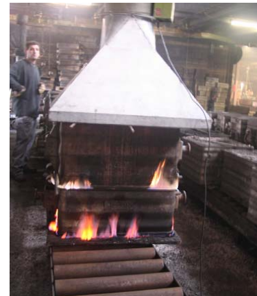
Absaugung der Gießgase an der Form
