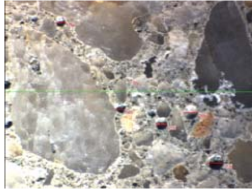
Mikroskopische Aufnahme von Beton mit Mikrohohlkugeln
