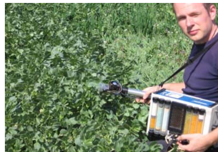
Erfassung des H_2O/CO_2 -Gaswechsels am Blatt mit einem Porometer an Ackerbohne
