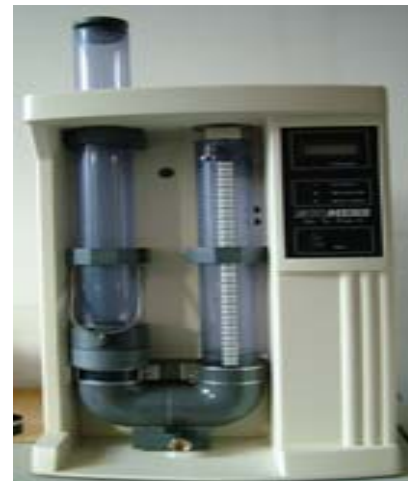
Bestimmung der Durchlässigkeit von Geokunststoffen ohne Auflast
