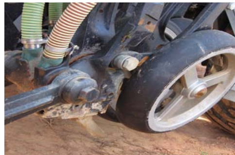
Cross-Slot - Direktsaatschar aus Neuseeland für den Bau der Direktsaatparzellen-Drillmaschine
