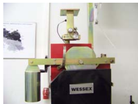
Schnellpoliermaschine für die Prüfung der Polierbarkeit von Gesteinskörnungen
