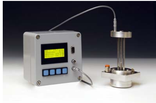
Labormuster eines akustischen Binärgassensensors mit Elektronikeinheit
