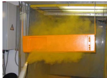
Pulverbeschichtung eines SMC-Bauteiles
