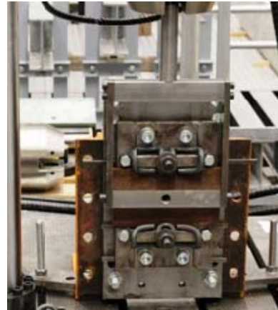
Dauerbelastungsversuch an Spannklemmen Horizontale Dauerfestigkeit nach BN 918 127 (3 Mio. Lastwechsel)
