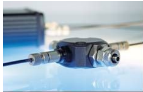
Prototyp eines H 2 S-Sensors auf Basis von Pd-PTFE-Nanokompositabscheidung
