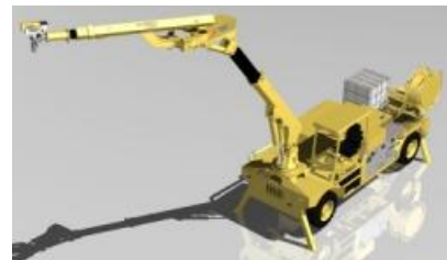
Virtuelle Betonspritzmaschine (Simulation)
