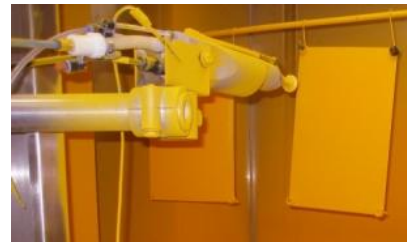
Versuchsaufbau der elektrostatischen Pulverlack-Sprühpistole zur Pulsation des Pulver-Luft-Stromes in der Beschichtungskammer
