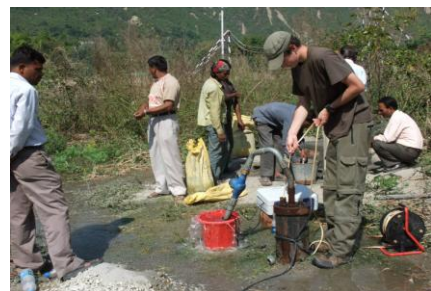
Probennahme aus einem Versorgungsbrunnen
