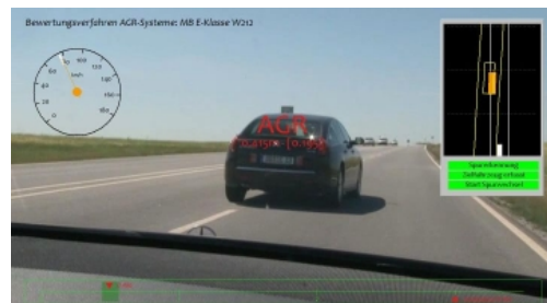
Kameraaufnahme des AGR-Reaktionspunktes bei einem Einschermanöver.
