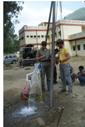
Pumpversuchsdurchführung in Agastmuni
