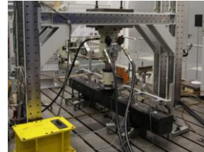
Durchführung der Ermüdungsprüfung mit der Kunststoffschwelle
