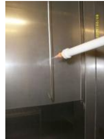
Airbrush -Pulverbeschichtung (verlustarme Feinstaubbeschichtung am dünnen Draht und Feinapplikation durch Punktstrahldüse)
