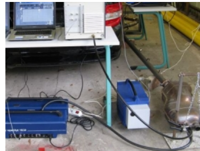
Abgasmessungen an einem Mercedes-Benz C 220 CDI mit Messgeräten der Firmen Junkalor und MAHA
