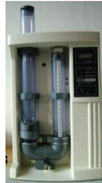
Bestimmung der Durchlässigkeit von Geokunststoffen ohne Auflast
