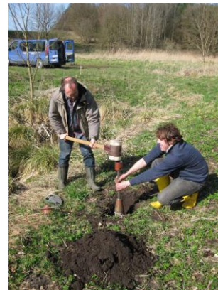
Einschlagen von Säulen zur Torfgewinnung für Versuche
