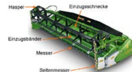
Antriebe beim Schneidwerk (Quelle TU-Dresden Professur AST)
