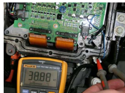
Analyse eines Steuergerätes im Fahrzeug Opel Ampera
