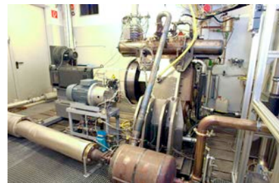
Motorenprüfstand mit Einzylinder Forschungsmotor
