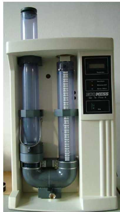
Bestimmung der Durchlässigkeit von Geokunststoffen ohne Auflast
