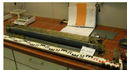
Spezifizierung von Torf- und Muddeproben im Labor
