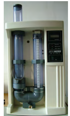
Bestimmung der Durchlässigkeit von Geokunststoffen ohne Auflast
