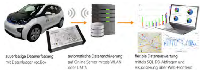
Abb. 1 Datenerfassung bei E-Fahrzeugen mit Datenlogger und Datenauswertung
