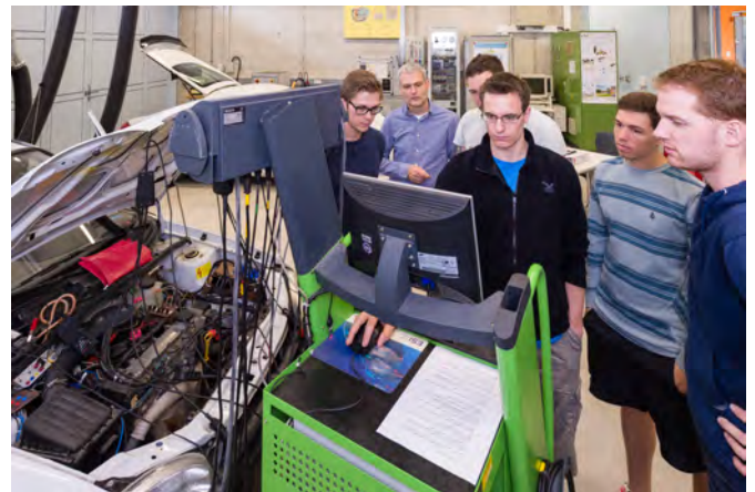
Studenten untersuchen mit dem Motortester in direkter Volladaption die Funktion der vollelektronischen Zündungsanlage eines kleinen Benzin-Verbrennungsmotors.
