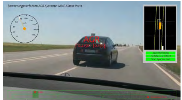
Kameraaufnahme des AGR-Reaktionspunktes bei einem Einschermanöver.
