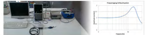
Versuchsaufbau zur Ermittlung des Übertragungsverhaltens
