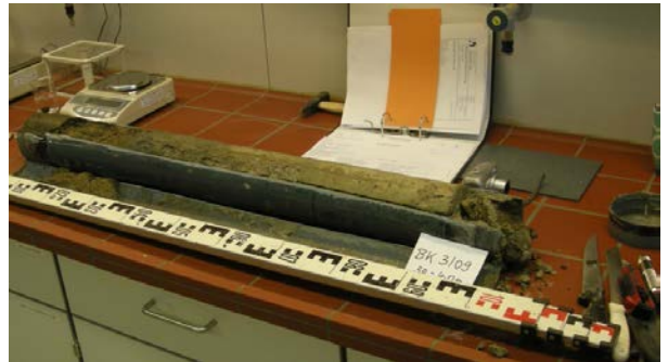
Spezifizierung von Torf- und Muddeproben im Labor
