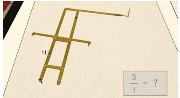
Ein Vergrößerungsverhältnis wird auf dem Storchenschnabel eingestellt
