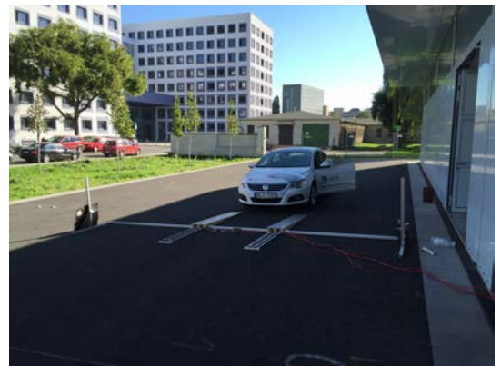
Mobiler Prüfstand zur Ermittlung der Dämpfungscharakteristik
