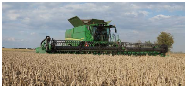
Mähdrescher mit elektrischem Schneidwerk bei der Ernterprobung Foto: TU Dresden
