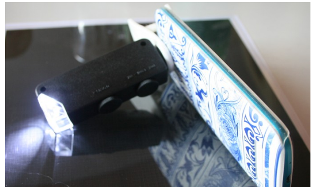
Smartphone mit Aufsteckmikroskop
