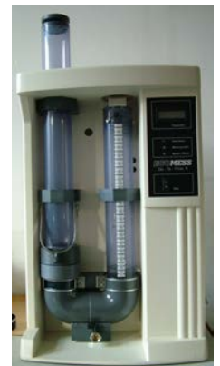
Bestimmung der Durchlässigkeit von Geokunststoffen ohne Auflast
