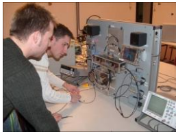
Versuchsplatz Demonstrator Verladebrücke (Programmierung, Sensorik, Aktorik)
