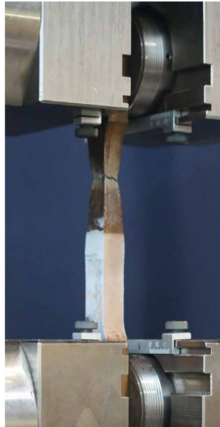
Bild 11 Tiefemperatur-Zugversuch an einer Querzugprobe einer Schweißung des Materials TFT Transverse tensile test at low temperature at a welded specimen of material TFT
