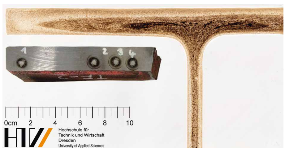
Bild 1 Baumannabdruck der Materialprobe TFS, zugehörige Probe der chemischen Analyse Sulphur print of the material sample TFS, related sample for chemical analysis
