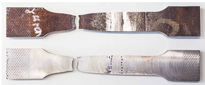
Bild 10 Querzugproben aus verschiedenen Schweißproben (Altstahl links, Neustahl rechts) Transverse tensile specimen of different welded samples (old steel left, new steel right)
