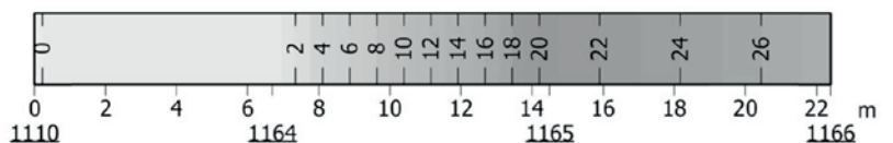
Bild 2. Eisenkonzentration in mg/L am Beginn der Entnahme (Neubrunnen 1110).
