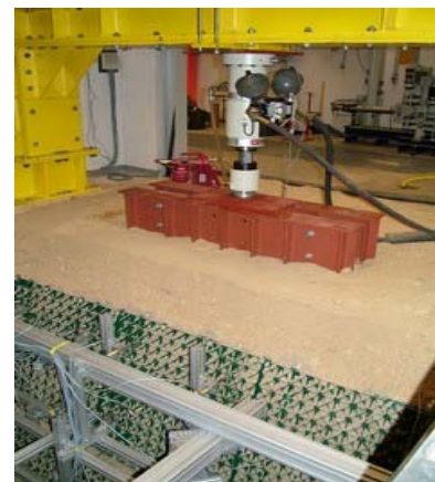
Belastungsversuch der Konstruktion aus geokunststoffbewehrter Erde
