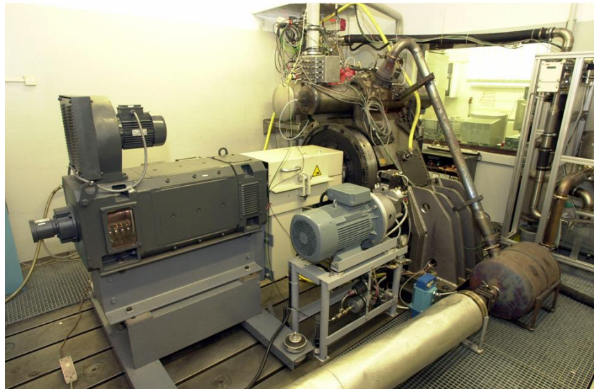
Motorenprüfstand mit Einzylinderdieselmotor MTU BR 382 mit Common-Rail-Einspritzung
