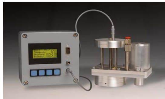
Labormuster eines akustischen Binärgassensors
