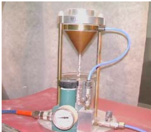
Bestimmung der Rieselfähigkeit hydrophober Pulverlacke mit dem HTW-Pulvermessplatz
