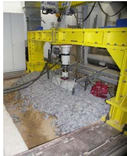
Ermittlung der elastischen Formänderung unter dynamischer Belastung
