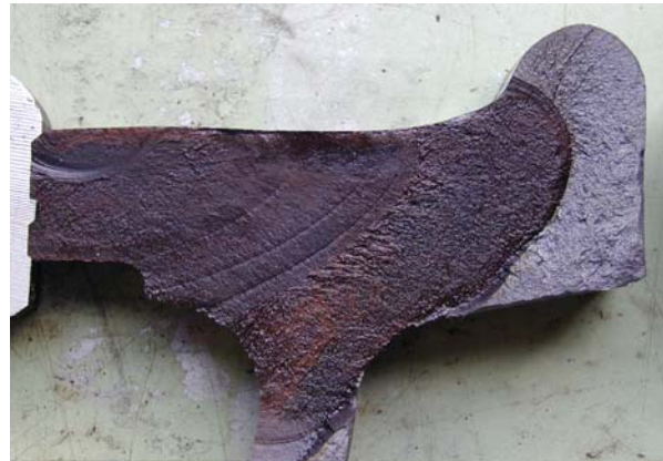
Schwingriss im Radkranz eines geschädigten Rades
