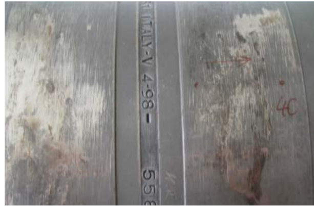
Schäden auf der Außenfläche eines Doppelkegelrollenlager-Außenringes
