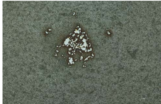
Nichtmetallische Einschlüsse in der Kernzone einer Radsatz-Achswelle
