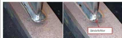
Beispiel einer HiFIT behandelten Schweißnaht
