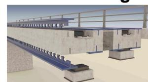
Überbauten in verschiedenen Bauweisen möglich: Massivbauweise, Spannbeton oder Stahl- und Stahlverbundbauweisen (z.B. WIB-Träger)
