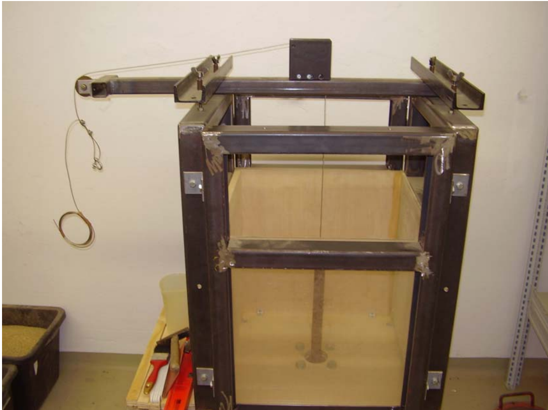
Abbildung 5 Modellversuchsstand für zyklische Herausziehversuche
