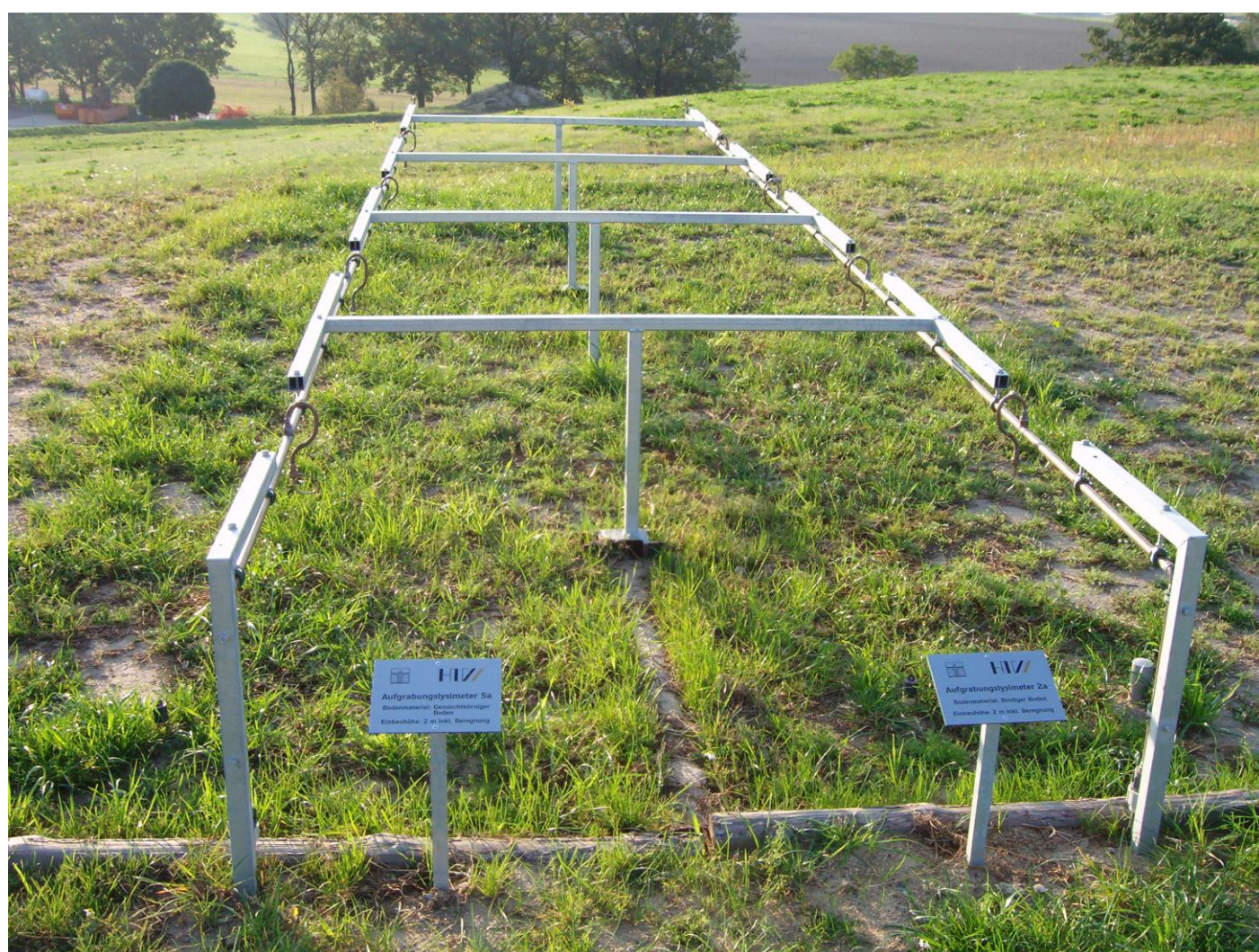
Abbildung 1: Aufgrabungsfelder mit Beregnung
