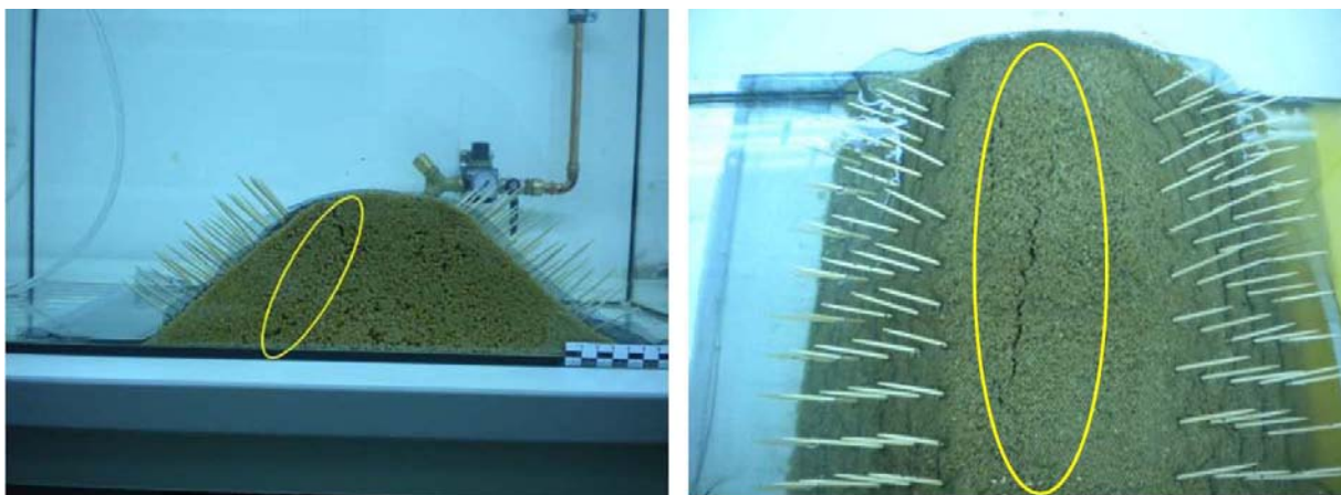
Abbildung 13: Gleitfugen und Stabilisierung mittels Böschungshaut im Modellversuch
