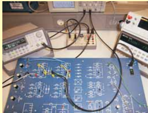
Grundschaltung Operationsverstärker A: invertierend, B: nicht invertierend
