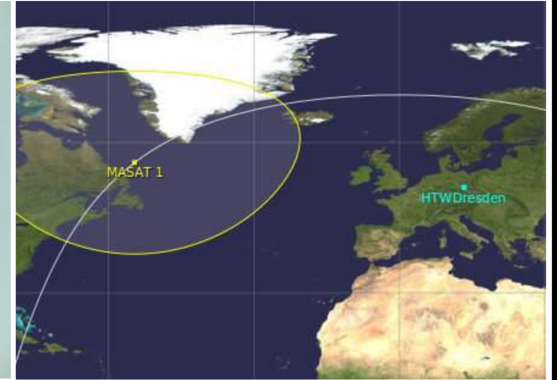
Bodenspur von CubeSat MaSat-1 im Programm GPredict
