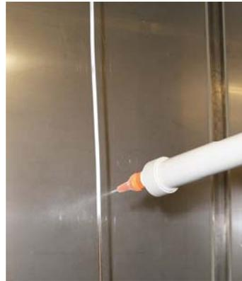
Abb. 2 Verlustarme Feinststaubbeschichtung am dünnen Draht
