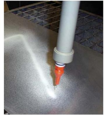
Abb. 3 Feinapplikation durch Punktstrahldüse
