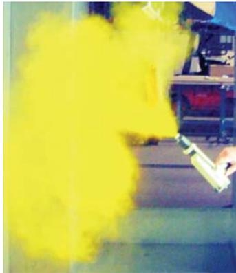
Abb. 1 Konventionelle Pulverbeschichtung mit breiter Pulverwolke
