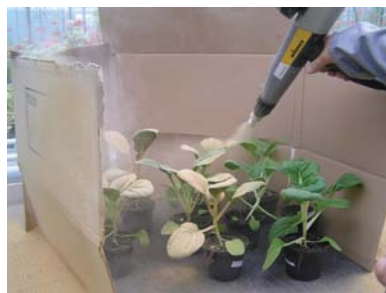
Abb. 2 Silikatapplikation mit Pulverlackierpistole (Koronaaufladung)
