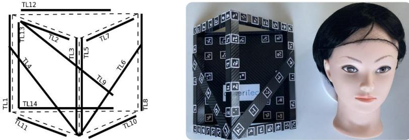
**Abb. 4** Referenzkörper (Abmessungen: 270 mm x 250 mm x 130 mm) mit Kontrollstrecken zur Systemkalibrierung im Größenvergleich zum verwendeten Kopf-Dummy.
