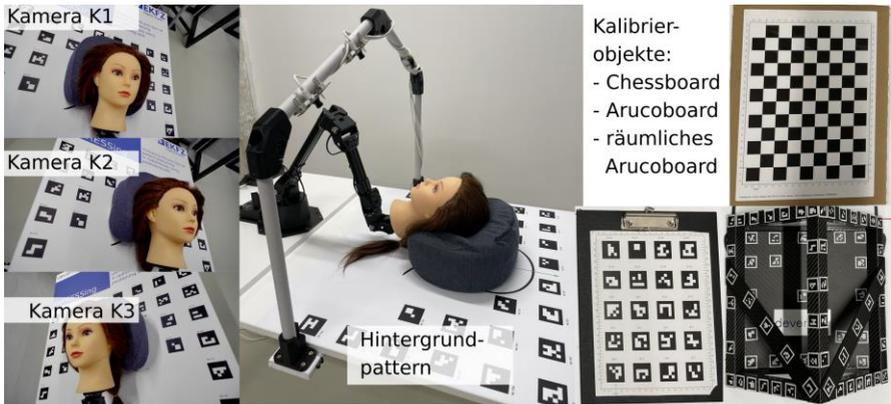
**Abb. 3:** Blickfeld und Kopfbereich im Bild einer der untersuchten Kameraanordnungen sowie die verwendeten Kalibrierkörper.
