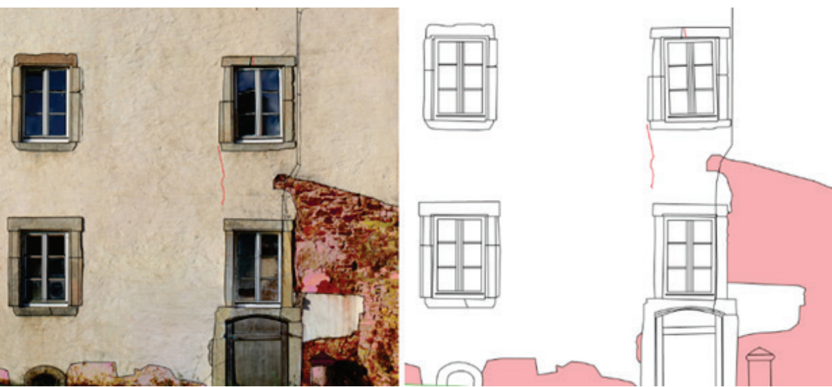
Ausschnitt aus dem Orthophoto mit überlagerter Schadenskartierung (links), CAD-Zeichnung (rechts)
