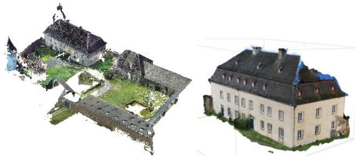
Abbildung 1: Bereinigte Punktwolke der Burginsel (links) und 3D-Modell des Herrenhauses (rechts)
