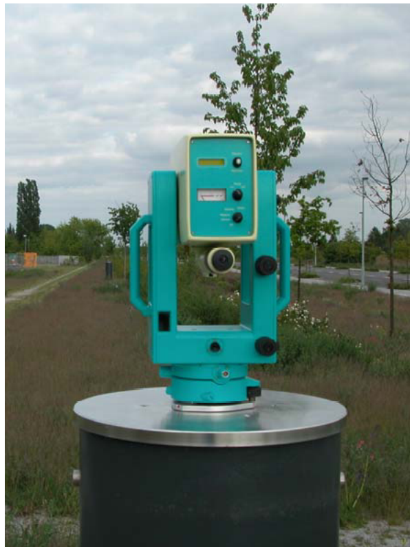
Abb.4 : Mekometer ME 5000 der ehem. Fa. Kern zur Sollstreckenbestimmung auf der EDM-Basislinie Berlin-Adlershof (aus Senatsverwaltung für Stadtentwicklung 2004)
