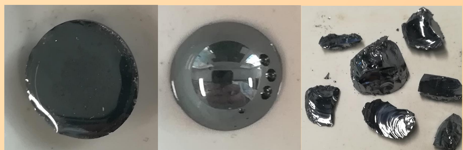
Abb. 2: Ober- und Unterseite sowie Bruchstücke der erstarrten Schmelzen der amorphen Probe Ag 0,25 As 0,375 Se 0,375 (Ag19)
