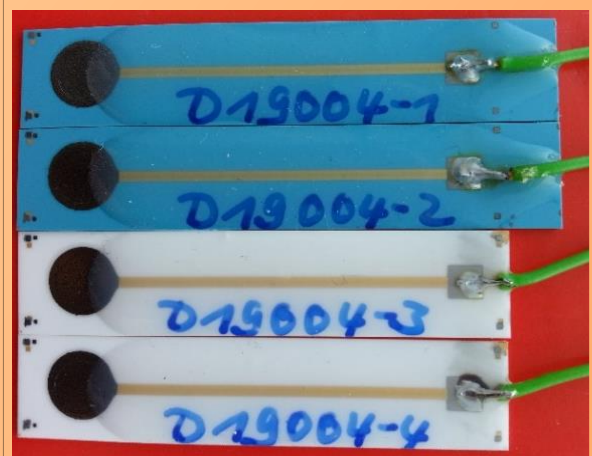
Abb. 9: Im Dickschicht-Verfahren gefertigte Cu 2+ -ISEs mit Probe Cu 0,07 Ag 0,205 As 0,362 Se 0,362 (CuAg1)
