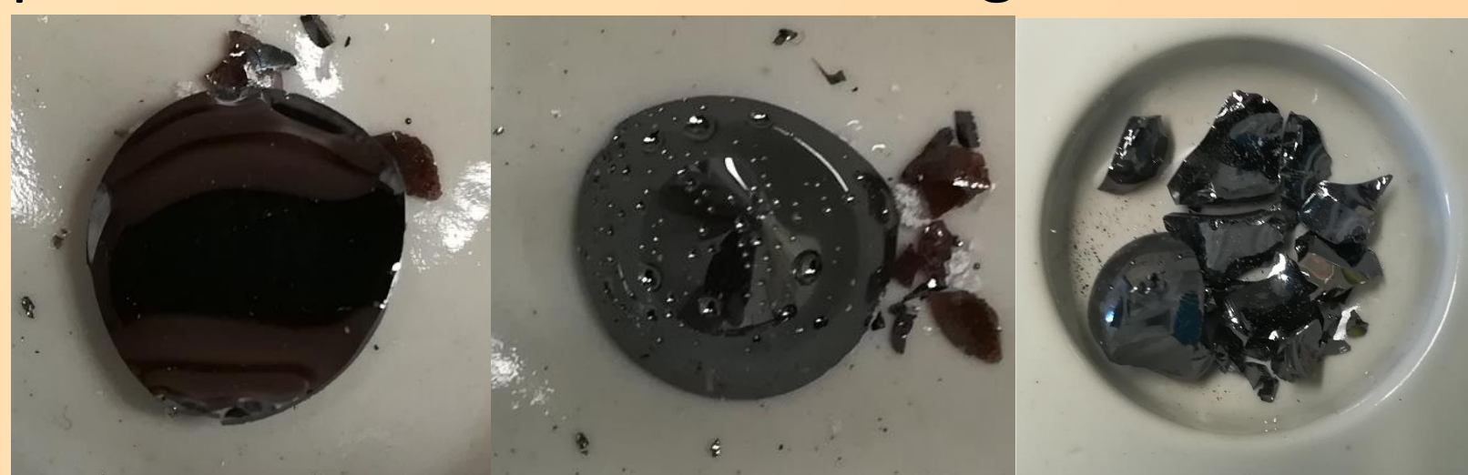
Abb. 1: Ober- und Unterseite sowie Bruchstücke der erstarrten Schmelzen der amorphen Probe Cu 0,25 As 0,375 Se 0,375 (Cu1)
