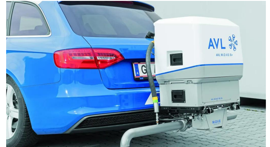
Beispielbild: Montage von PEMS-Komponenten an einem PKW
