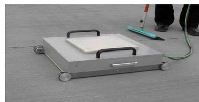
Laserscanner zur digitalen Erfassung der Oberflächenstruktur
