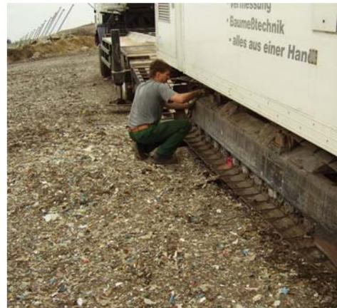
Drucksondierung auf einem Probefeld mit MBA Material
