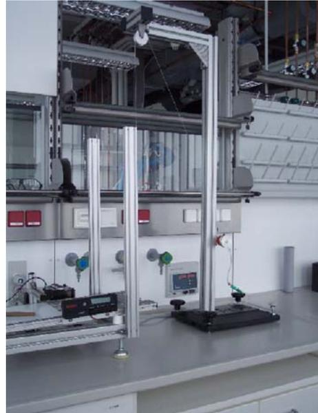
Gleitwinkelmeßapparatur zur Bestimmung der statischen Reibungszahl
