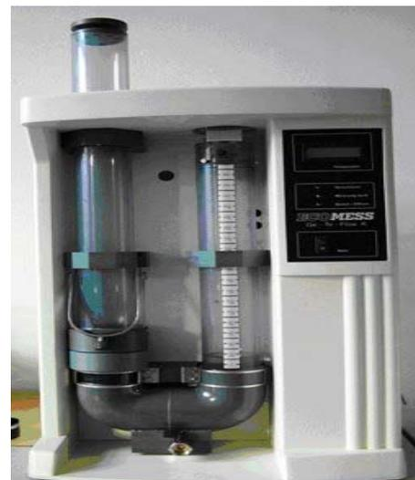
Bestimmung der Durchlässigkeit von Geokunststoffen ohne Auflast
