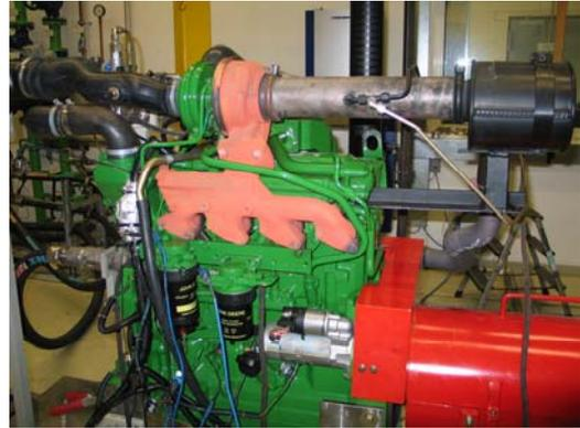
Erprobungsträger: John Deere Motor mit Umrüstung auf Pflanzenölbetrieb
