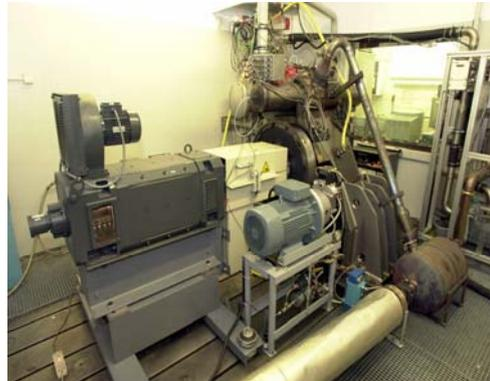
Motorenprüfstand mit Einzylinderdieselmotor MTU BR 382 mit Common-Rail-Einspritzung
