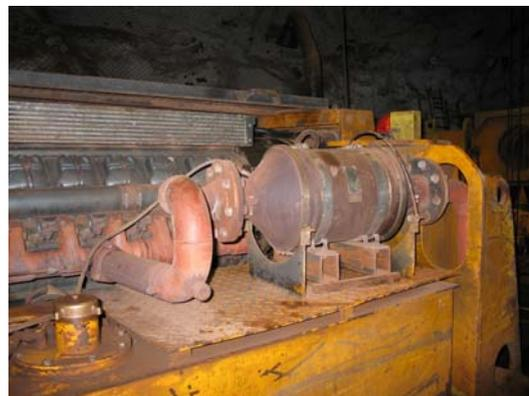
Partikelfiltersystem mit Partikelsensoren an einem Fahrlader für den Untertage-Einsatz
