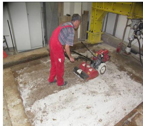
Vorbereitung des Großversuches - Herstellung einer Bodenverbesserung
