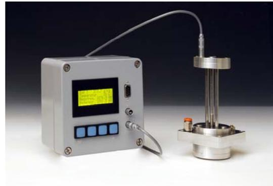
Labormuster eines akustischen Binärgassensors mit Elektronikeinheit
