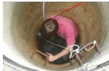
Kamerabefahrung und Probennahme in einem Quellschacht
