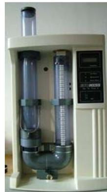
Bestimmung der Durchlässigkeit von Geokunststoffen ohne Auflast
