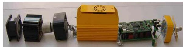
Permanentmagneterregte Drehstrom-Synchronmaschine mit Lagesensor
