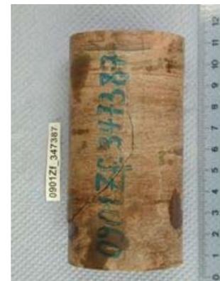
Prüfkörper nach einaxialem Druckversuch
