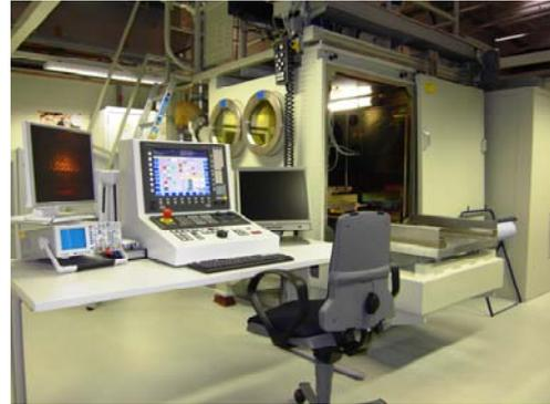
Elektronenstrahlanlage mit Arbeitskammer und Bedieneinheit
