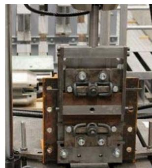
Dauerbelastungsversuche an Spannklemmen Horizontale Dauerfestigkeit nach BN 918 127 (3 Mio Lastwechsel)
