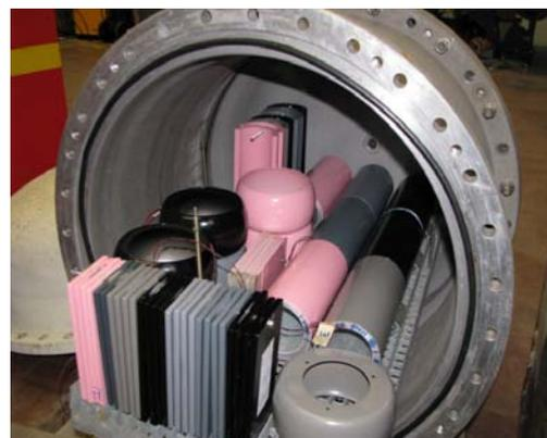
SF<sub>6</sub>-Prüfung pulverbeschichteter Hochspannungskomponenten
