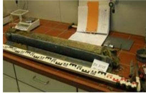
Spezifizierung von Torf- und Muddeproben im Labor
