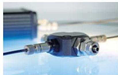
Prototyp eines H<sub>2</sub>S-Sensors auf Basis von Pd-PTFE-Nanokompositabscheidung
