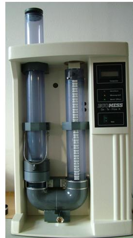
Bestimmung der Durchlässigkeit von Geokunststoffen ohne Auflast
