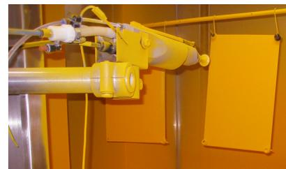
Versuchsaufbau der elektrostatischen Pulverlack-Sprühpistole zur Pulsation des Pulver-Luft-Stromes in der Beschichtungskammer
