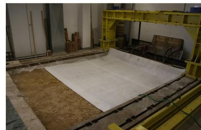
Einbau des Geoverbundstoffes im Großversuchsstand Verkehrswegebau
