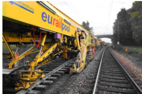
Gleisbaumaschine PM 1000-URM
