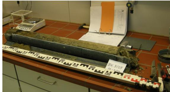
Spezifizierung von Torf- und Muddeproben im Labor
