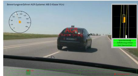
Kameraaufnahme des AGR-Reaktionspunktes bei einem Einscherer
