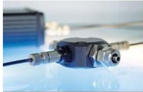
Prototyp eines H<sub>2</sub>S-Sensors auf Basis von Pd-PTFE-Nanokompositabscheidung
