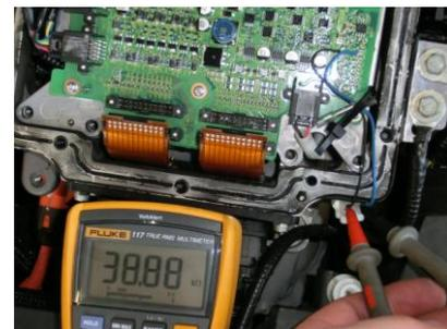
Analyse eines Steuergerätes im Fahrzeug Opel Ampera
