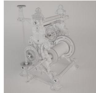
Das Modell eines Uhrwerks
