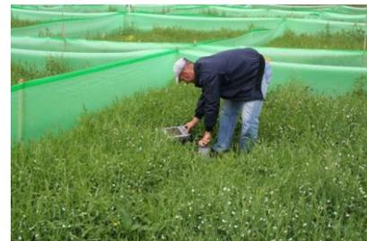
Erfassung der CO<sub>2</sub>-Entbindung aus dem Boden in Saat-Platterbse
