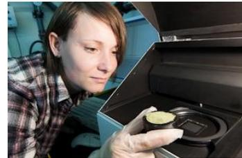
Probenkontrolle vor der Messung im NIR-Spektrometer
