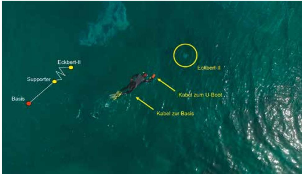
Abb. 2: Ein Blick von oben: Das lange Kabel verläuft von der Basis bis zum Taucher, der das U-Boot begleitet. Von dort dokumentiert Eckbert-II das Schiffswrack in sechs Metern Tiefe.
