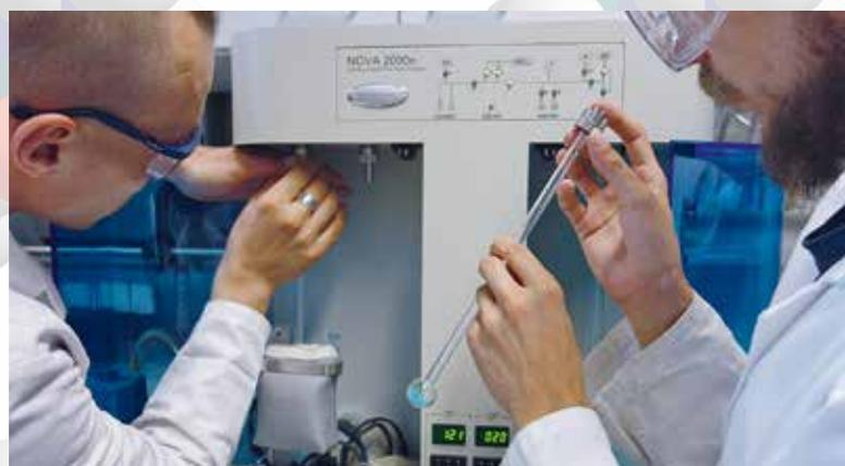
Abb. 2: Vermessung der Stickstoffadsorption an einer metall-organischen Gerüstverbindung.
