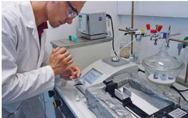
Abb. 4: Probenvorbereitung zur Vermessung der Flüssigphasenadsorption an einer Aktivkohle.
