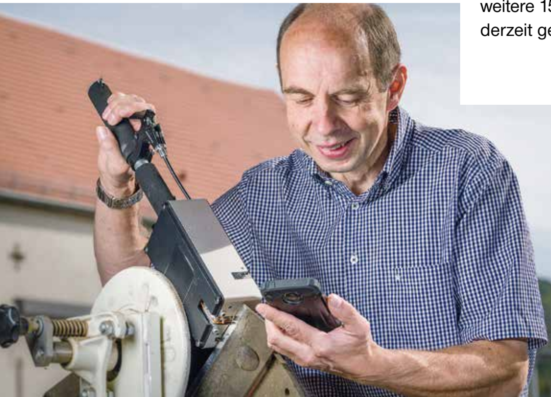
Prof. Wild beim Einsatz seines Gerätes zur Messung der Messerschärfe an der Klinge eines Laborschärfers.
