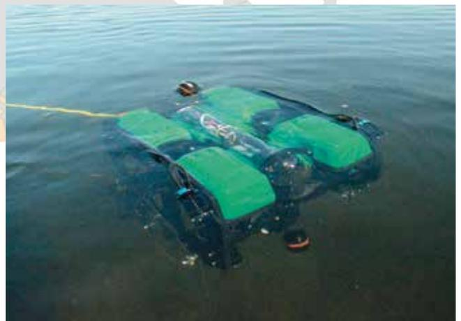
Testtauchfahrt des halbautonomen unbemannten Unterwasserfahrzeugs (UUV) Cousteau-II
