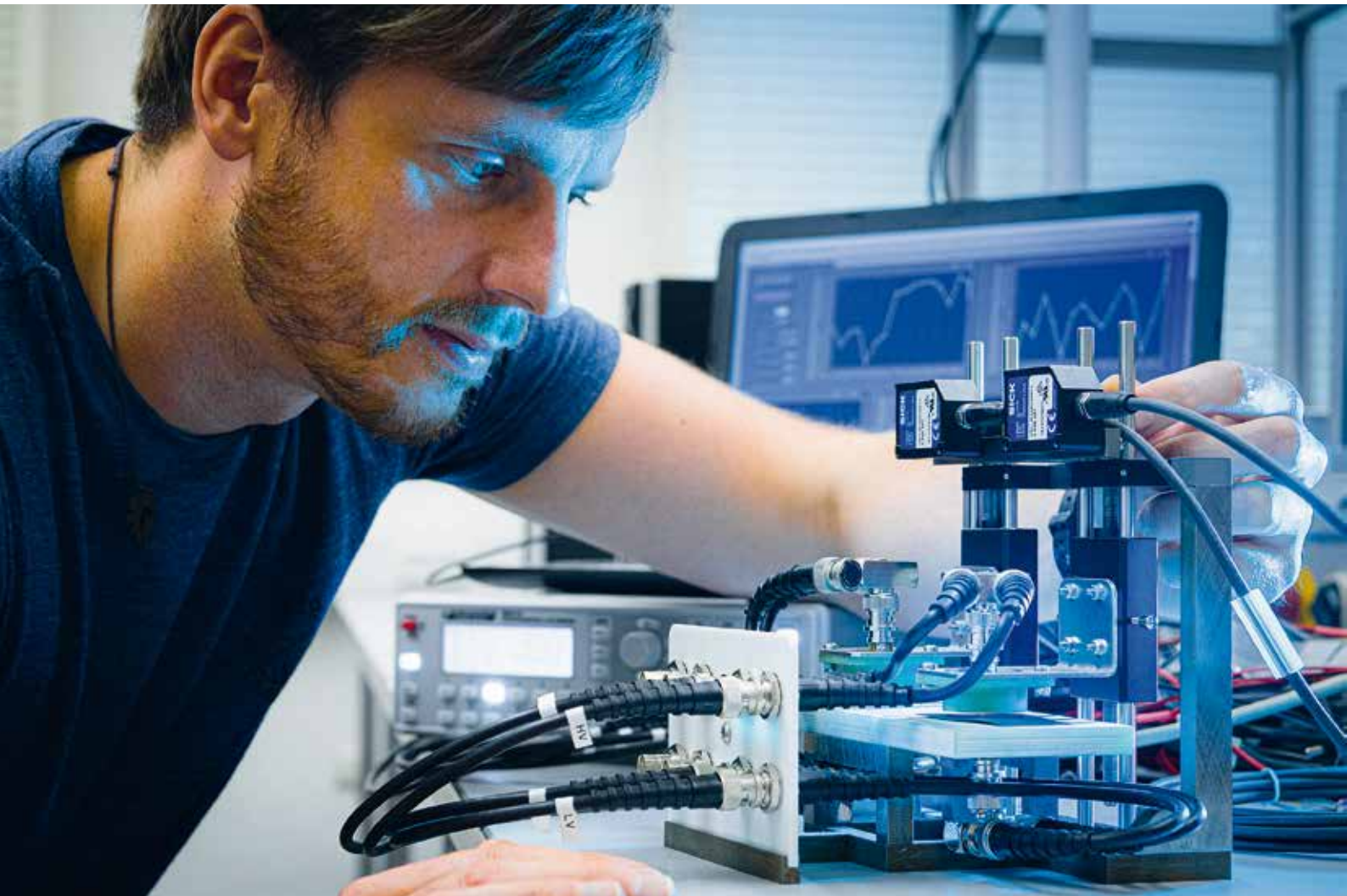
Henry Kettwig untersucht die sensorischen Eigenschaften eines Biokunststoffes auf Gelatinebasis.
