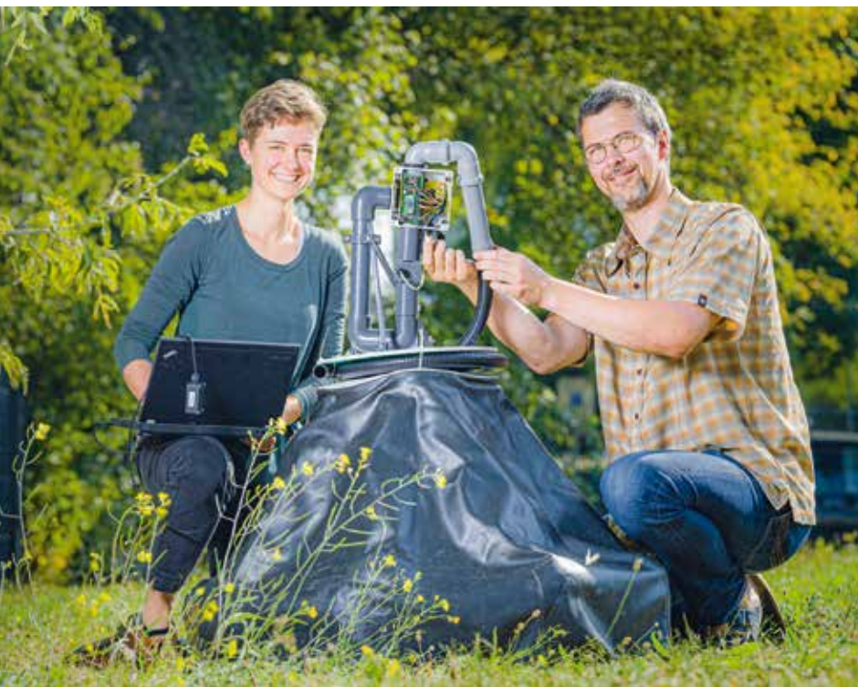
Hilke Zündorf und André Spindler mit eigens entwickelter Technik zur Messung des Sauerstoffeintrags im Belebungsbecken
