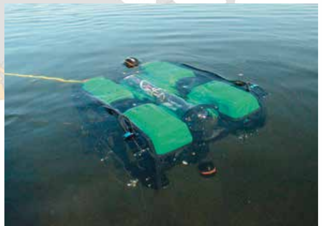
Testtauchfahrt des halbautonomen unbemannten Unterwasserfahrzeugs (UUV) Cousteau-II
