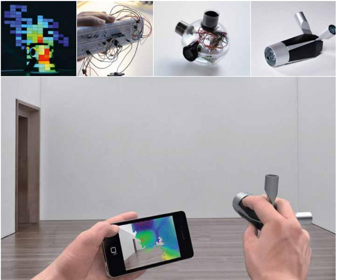
Masterarbeit von Manuel Milde: Entwicklung eines Gerätes, das, zusammen mit einem Smartphone, kostengünstig Wärmedaten an Gebäuden erfassen und analysieren kann. Entwurf eines anwendungsfähigen Prototyps sowie eines Designmodells.
