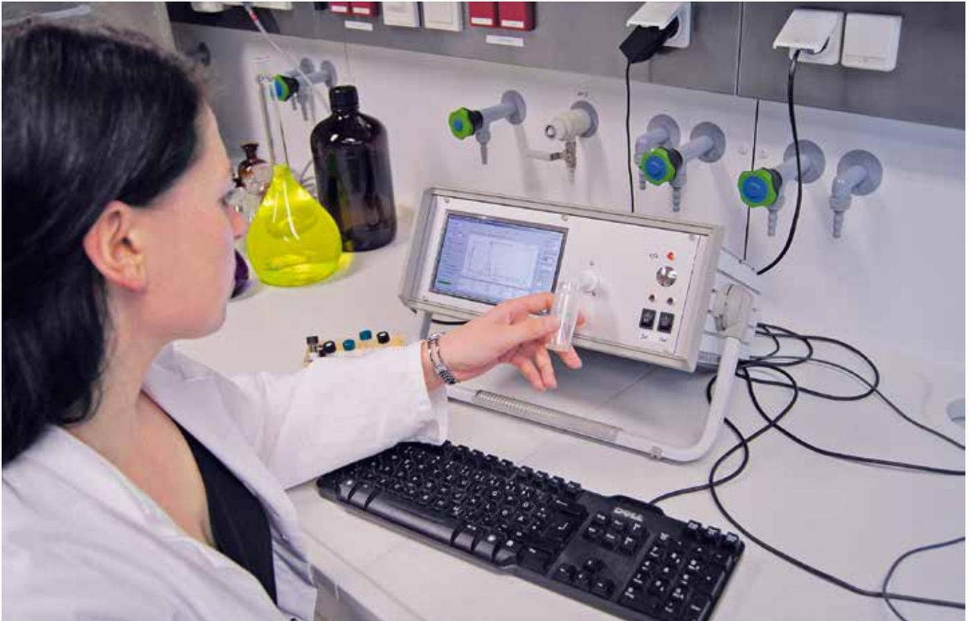
Ionenmobilitätsspektrometer - Geruchsidentifikation mittels Clusteranalyse
