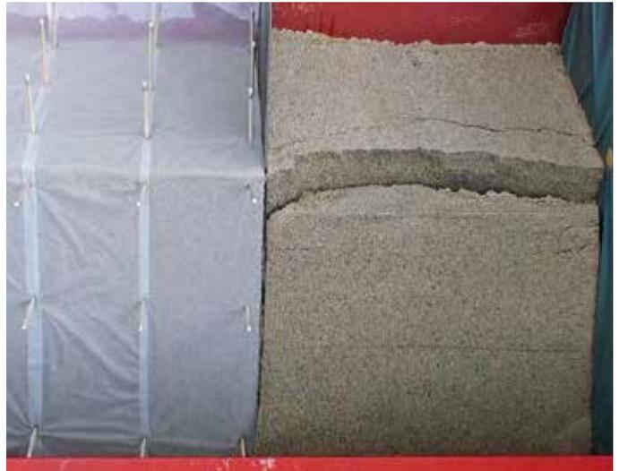
Abb. 4: Modellversuch an einer 60° steilen Böschung mit und ohne Außenhaut
