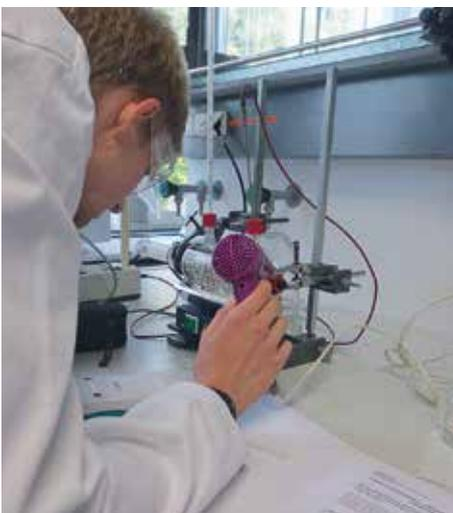
Überprüfung der vollständigen Verdampfung der organischen Flüssigkeit.
