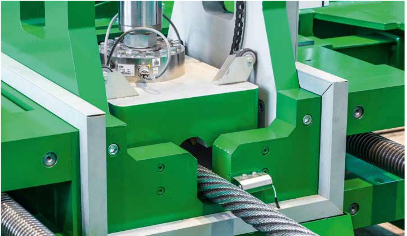
Reibwertprüfstand in der Versuchshalle der Firma Kluge
