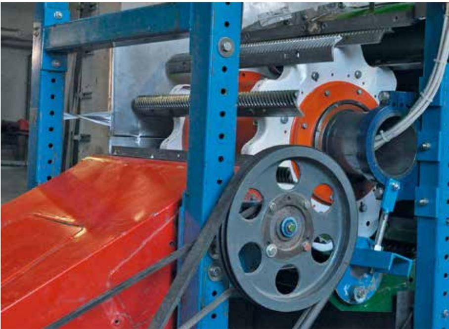
Elektrische Dreschtrommel im Laborversuchsstand an der TU Dresden
