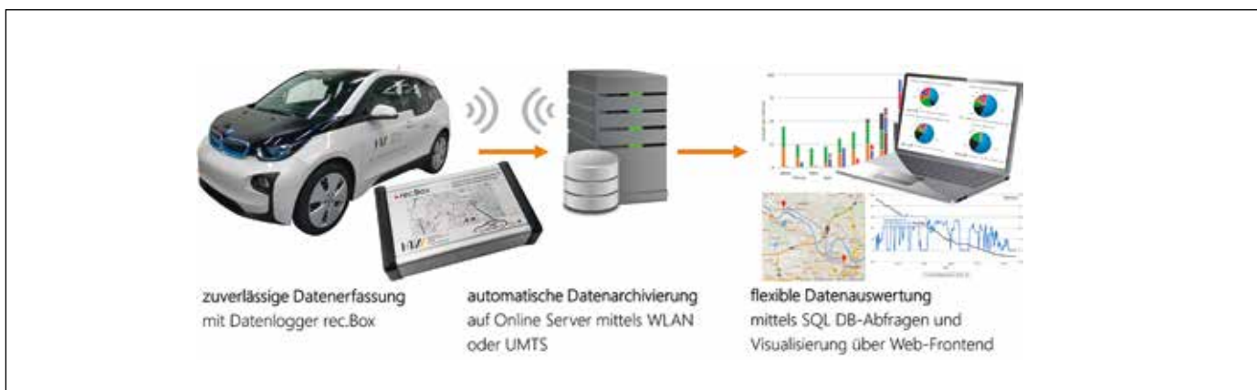
Abb. 1: Datenerfassung bei E-Fahrzeugen mit Datenlogger und Datenauswertung
