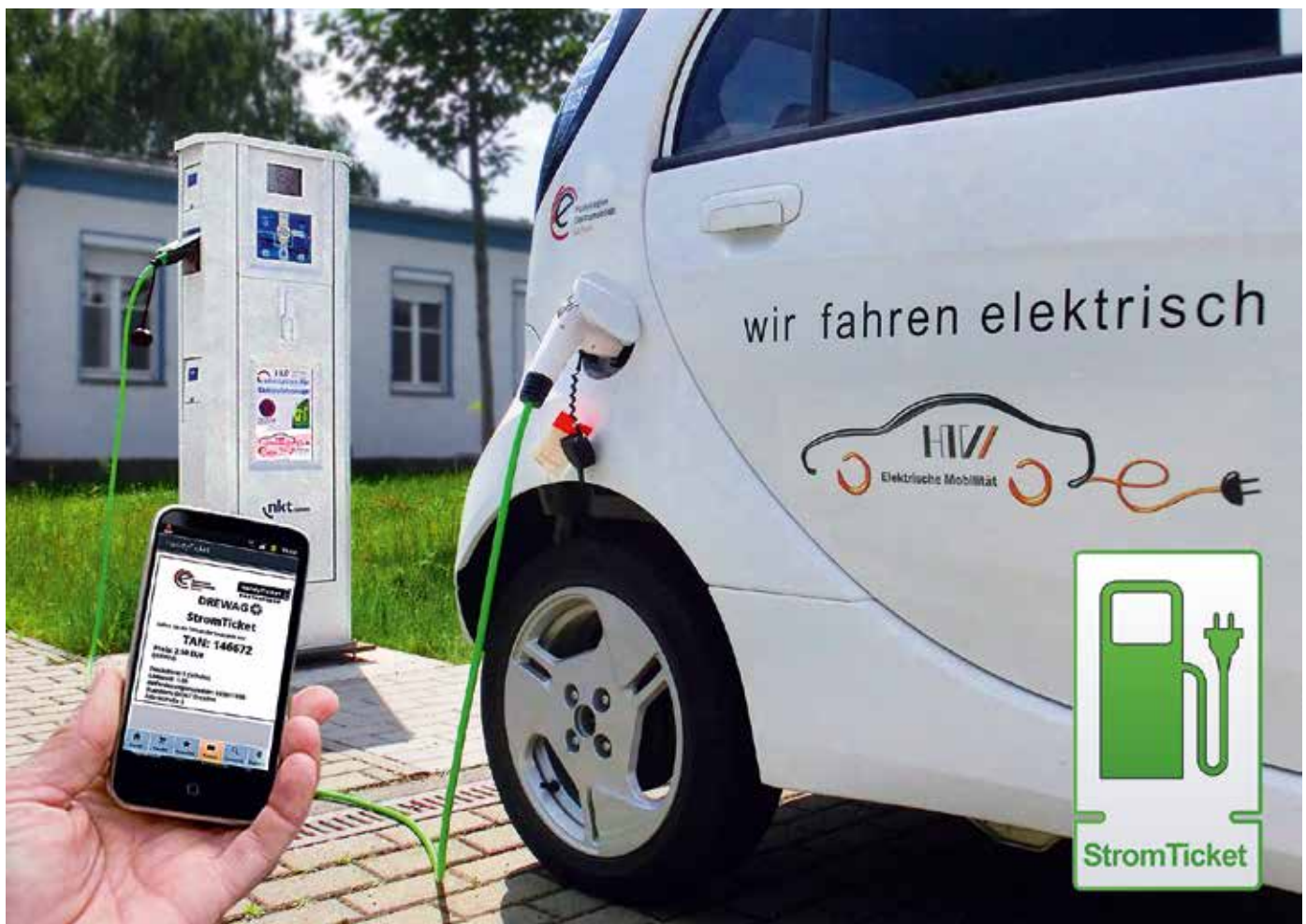
Abb. 3: Verwendung der StromTicket-App für die Ladung der Traktionsbatterie eines Mitsubishi i-MiEV
