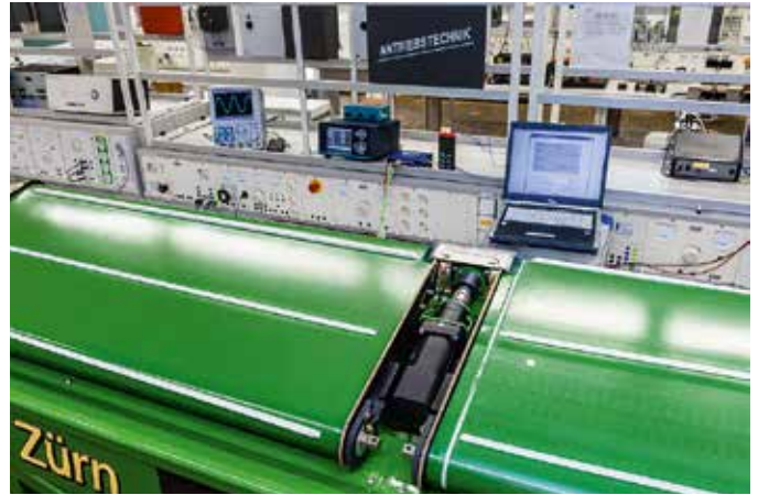
Abb. 2: Testanlage Bandantriebe im HTW-Antriebslabor bei der experimentellen Untersuchung
