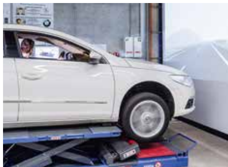
Fahrsimulation am neuen Prüfstand für Assistenzsysteme
