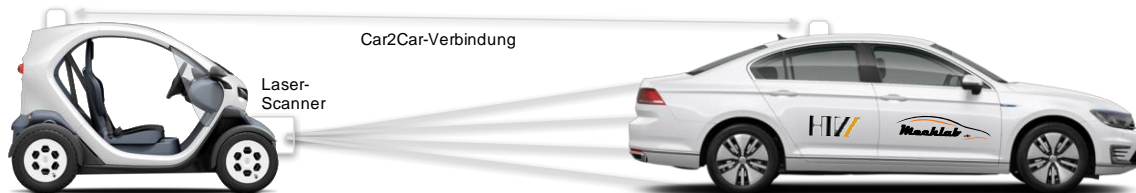
Sensorik und Fahrzeuge für die Funktion „Platooning“
