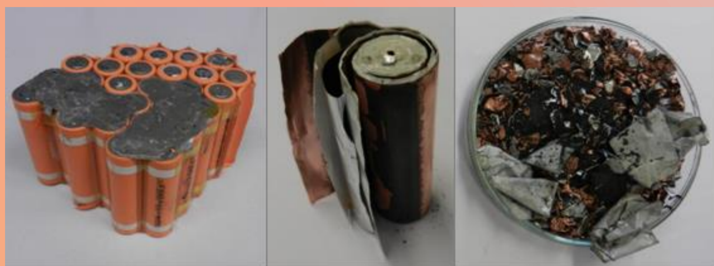
Abbildung 2: Rundzellen vor und nach Recycling
