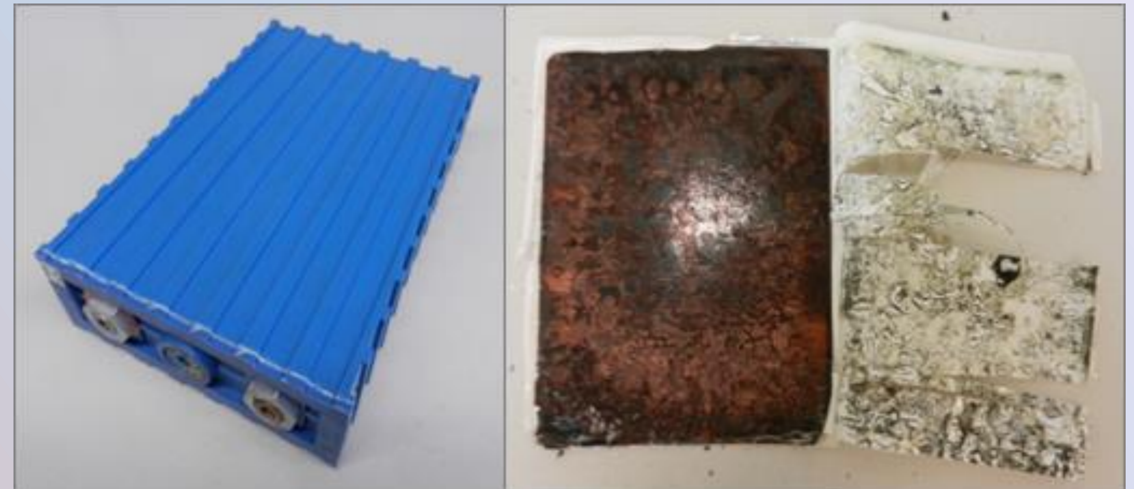
Abbildung 5: Prismazelle, Al-Folie mit Cu-Ablagerungen und Separatorfolie
