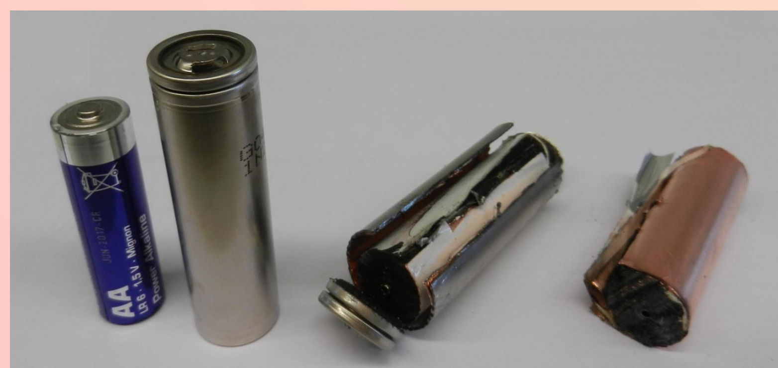
Abbildung 2: Verwendete Zellen mit Größenvergleich (links), geöffnet (mitte) und enthaltenes Folienbündel (rechts)
